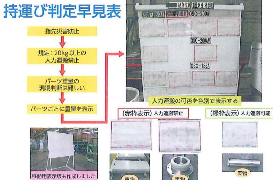
重量20kg以上のものの人力運搬は禁止としているが、機械部品の重量を現場で判断するのは難しい。そこで、図面を色分けして現場に表示し、人力運搬可否の見える化を図った。
