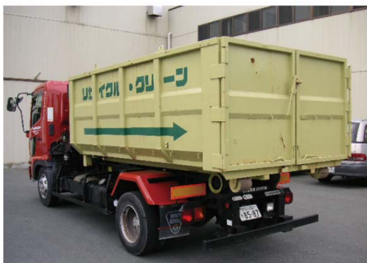
図14 【4 t 大型フックロール（8 m 3 ）】
